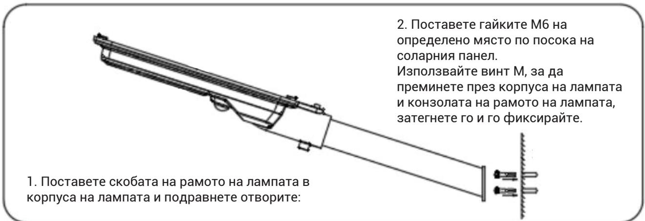
3. Маркирайте монтажния отвор на стената, която ще се монтира, и пробийте отвора със зареждаща бормашина; Забийте разширителния винт в стената.
