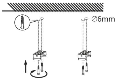
Setzen Sie die Dübel richtig in die Bohr-
