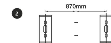
Bohren Sie je zwei Löcher pro Seite á 6mm. Der Abstand zwischen den Bohrlöchern beträgt 870mm.
