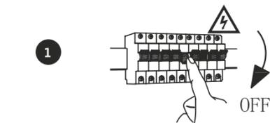
Schalten Sie vor der Installation die Hauptstromquelle aus, indem Sie den Sicherungsautomat ausschalten bzw. die Sicherung herausdrehen, um einen elektrischen Schlag zu vermeiden. Gegen Wiedereinschalten sichern.
