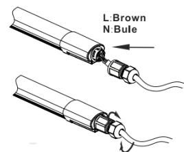
Lösen Sie den Schraubverschluss und
