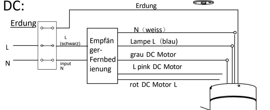
Empfängerplatz: Hängen Sie den Motor am linken Haken ein und führen Sie dann die Verkabelung durch
