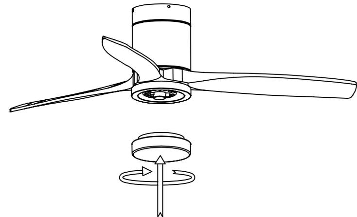
Bringen Sie die Abdeckung Lampe an und befestigen Sie sie mit Zierklammern und Schraubenmuttern.
