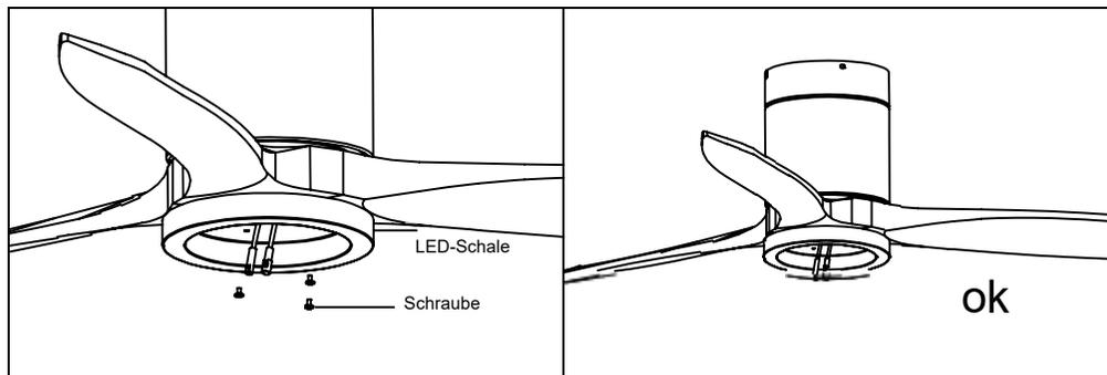
Lösen Sie eine Stellschraube. Befestigen Sie die Wanne an der Unterseite des Lüfters, indem Sie die anderen beiden Stellschraubenköpfe in die Schlüssellochschlitze einsetzen, drehen Sie sie, um sie zu platzieren, befestigen Sie dann die vorherige Stellschraube, indem Sie das Schraubenloch und das Loch an der Unterseite des Lüfters ausrichten, und ziehen Sie sie fest. Die restlichen zwei Stellschrauben befestigen die LED-Schale.
