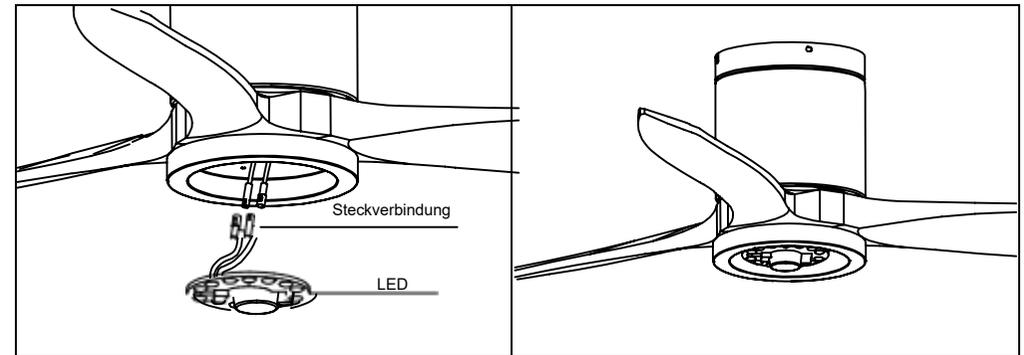
Verbinden Sie die LED-Platine an den zwei Steckverbindungen mit der Lampe.
