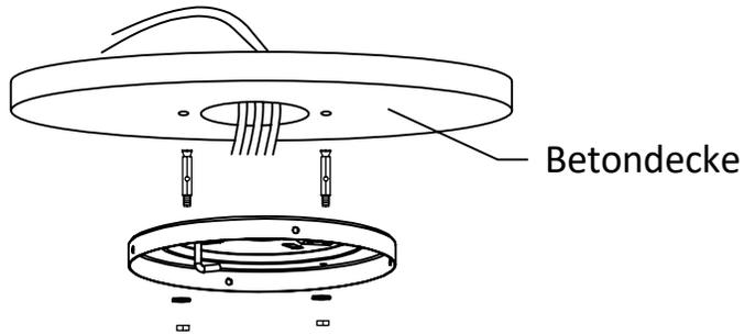
Bitte bohren Sie ein Loch mit einem Durchmesser von 8 mm in die Betondecke und setzen Sie die Schraube ein. Richten Sie die Halterung am Loch aus und ziehen Sie sie dann mit der Mutter fest.
