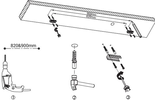
Schritt 1: Befestigen Sie die Montageclips an der Decke
