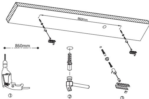
Schritt 1: Befestigen Sie das Drahtseil an der Decke und schlieen Sie die Montageklemme am Drahtseil an.
