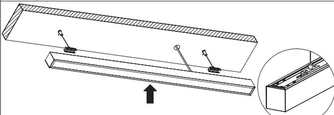
Schritt 2: Stecken Sie den Montageclip in die Vorrichtung am Lampenkorper
