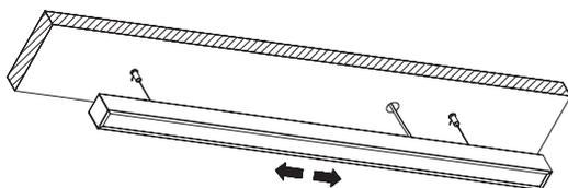
Schritt 3: Zum Abnehmen der Leuchte schieben Sie diese nach links und rechts.
