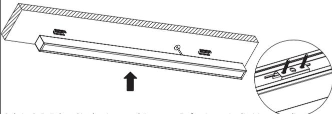
Schritt 2: Drucken Sie den Lampenkorper zur Befestigung in die Montageclips.
