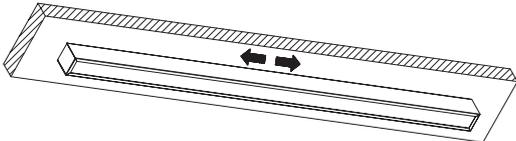
Schritt 3: Zum Abnehmen der Leuchte schieben Sie diese nach links und rechts.
