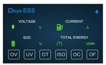
(4) Geben Sie das Passwort 123 ein und drücken Sie die Taste Bestätigen, um die Hauptschnittstelle der Systemwartung aufzurufen. Die Operation muss von einem Fachmann durchgeführt werden.
