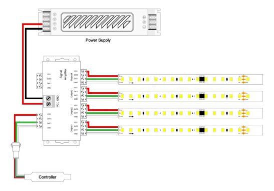
Verbinde den Streifen mit dem Verstärker. Bitte stellen Sie sicher, dass das richtige Kabel verwendet wurde. Falls ein Stecker am Streifen angelötet ist schneiden Sie diesen ab und anschließend verbinden Sie den Controller mit dem Verstärker. Danach verbinden Sie das Netzteil mit dem Verstärker. Schalten Sie das Netzteil ein und überprüfen Sie die Istallation.
