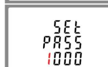
Drücken Sie **B**, um die Routine zum Ändern des Kennworts aufzurufen. Der Bildschirm für das neue Passwort wird angezeigt, wobei die erste Ziffer blinkt.
