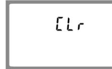
Der Zähler bietet eine Funktion zum Zurücksetzen des maximalen Bedarfs von Strom und Leistung.
