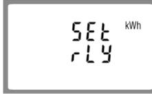
Drücken Sie **B**, um die Auswahlroutine aufzurufen. Das Einheitensymbol blinkt.
