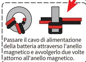
Passare il cavo di alimentazione della batteria attraverso l'anello magnetico e avvolgerlo due volte attorno all'anello magnetico.
