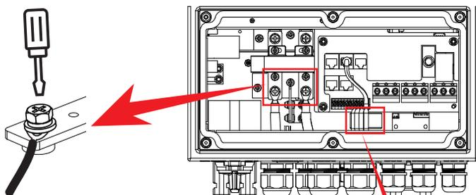
Per il modello da 3/3.6/5/6 kW, dimensioni della vite del connettore della batteria: M6
