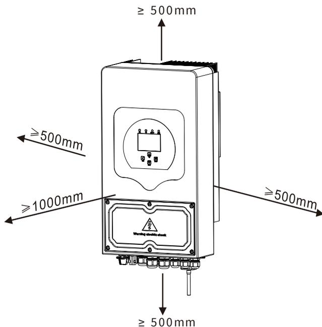
Per una corretta circolazione dell'aria per dissipare il calore, lasciare uno spazio libero di ca. 50 cm di lato e ca. 50 cm sopra e sotto l'unità. E 100 cm in avanti.
