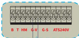
GV/GS: segnale di contatto pulito per l'avvio del generatore diesel.
