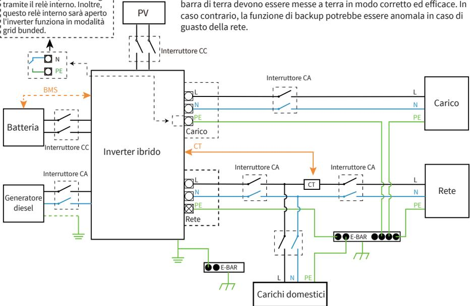
Questo diagramma è un esempio di un'applicazione in cui il Neutro si collega con PE nella scatola di distribuzione. Come in Australia, Nuova Zelanda, Sud Africa, ecc. (Seguire le normative locali sul cablaggio!)
