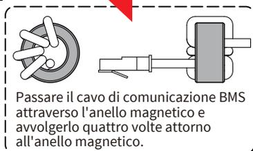
Passare il cavo di comunicazione BMS attraverso l'anello magnetico e avvolgerlo quattro volte attorno all'anello magnetico.
