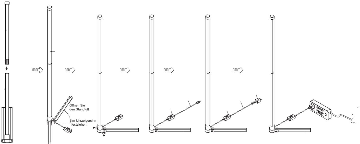
1. Stecken Sie das Aluminiumprofil und den Verbinder zusammen um diese zu befestigen
