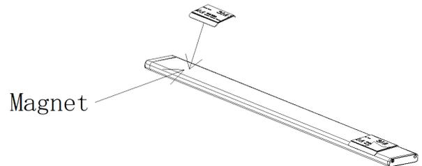
3. Ziehen Sie die zweite Klebeschicht auf der Rückseite der Metallclips ab und kleben Sie die Leuchte an die gewünschte Position (reinigen Sie die Fläche von Staub bevor Sie die Leuchte befestigen). Prüfen Sie erneut den Halt der Leuchte.
