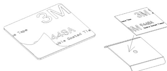
Ziehen Sie die Schutzschicht des doppelseitigen Klebebands ab
