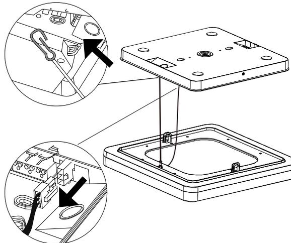
2.2 Entfernen Sie das Anschlusskabel
