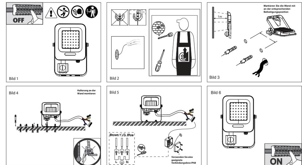
Installieren Sie die LED-Flutlichter am Boden, an der Wand oder an der Decke (nur im Außenbereich)
