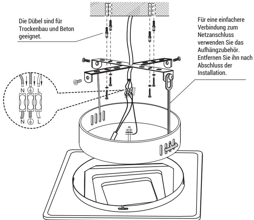
Schließen Sie die Stromkabel an die Klemme an. Wenn Sie das Gerät auf einer Metalloberfläche installieren, müssen Sie diese erden.
