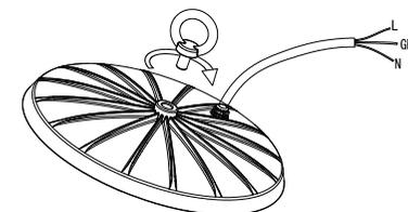
2- Verbinden Sie die Stromleitung mit der Leuchte.
